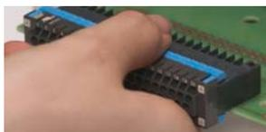
独自の構造\*1で、接触信頼性を確保しつつ、片手での簡単な着脱を実現しました。
