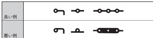
自動はんだ後、手はんだ付けによる部品およびリレーを後づけする場合、ランドの一部に切り欠け部を設けることで、端子穴を確保できます。
