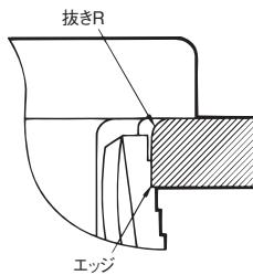
パネル加工時の抜きRがスイッチ操作面側となるようにしてください。
