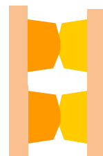
【ツイン接点 / G9KA】 100A / 接点* 2
