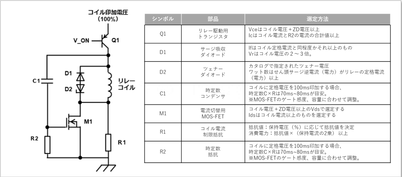
図9:保持電圧CR回路例、周辺部品の選定方法
