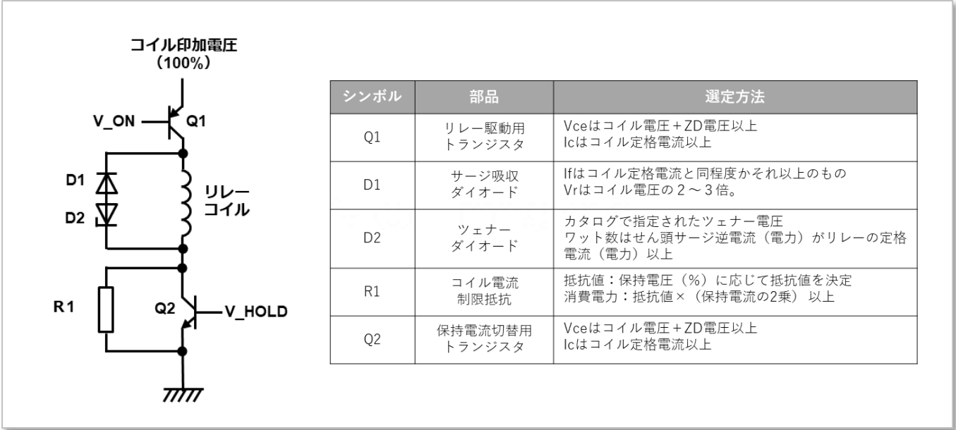
図11.スイッチによる保持電圧回路図例、周辺部品の選定方法
