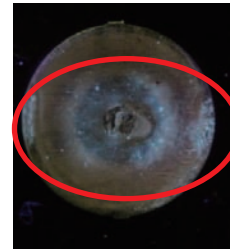
接点表面にフラックスが 付着し、接触不良になる
