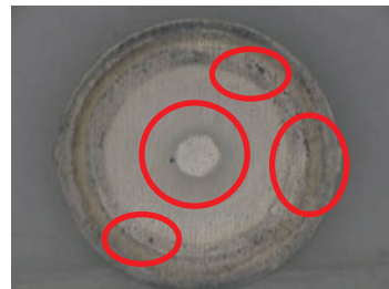
接点表面に塵埃が付着し、 接触不良になる
