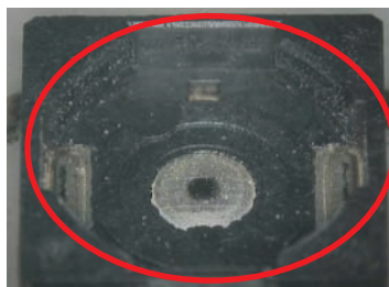
プランジャとカバーの 隙間から塵埃侵入
