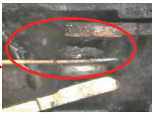
接点部が腐食している
