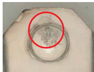
腐食物が生成している
