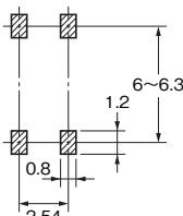
\*SOP4ピンと外形寸法が異なりますが、実装パッド寸法は同一です。
