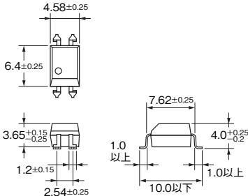
プリント基板加工寸法(BOTTOM VIEW)
