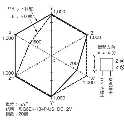
測定：3軸6方向に無励磁で3回、励磁で3回、それぞれ衝撃を加え接点の誤動作を生じる値を測定。
