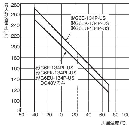
注：最大許容電圧は、リレーコイルに印加できる電圧の最大値です。
