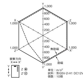
測定：3軸6方向に励磁で3回、無励磁で3回、
