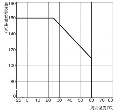
注: 最大許容電圧は、リレーコイルに印加できる最大の電圧です。
